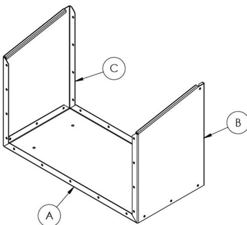
**Étape 2 :** Boulonner les panneaux arrière et avant sur le panneau de fond et les panneaux latéraux déjà assemblés de la boîte en insérant les boulons par l'extérieur de manière à ce que les écrous soient à l'intérieur de la boîte. Serrer les écrous à la main seulement à cette étape.
