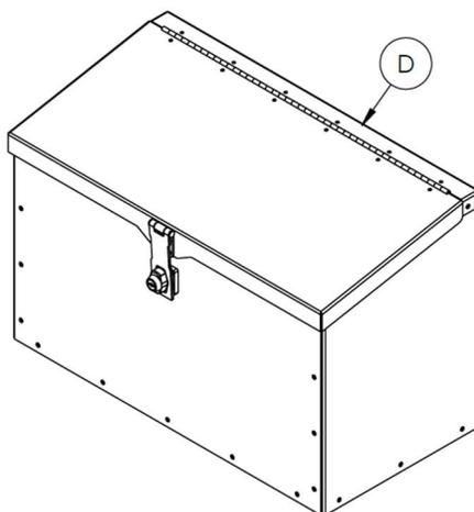
**Étape 4 :** Fixer la boîte à colis au sol avec 4 ancrages ou vis (selon le type de sol) en utilisant les rondelles de fixation fournies.
