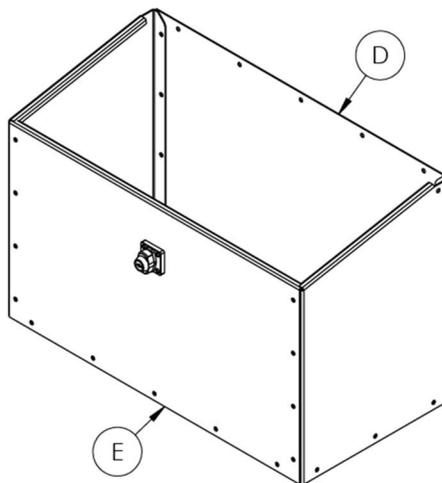
**Étape 3 :** Boulonner le couvercle avec la boîte déjà assemblée en insérant les boulons par l'extérieur de manière à ce que les écrous soient à l'intérieur de la boîte. Vous devez maintenant serrer tous les écrous avec la clé anglaise.
